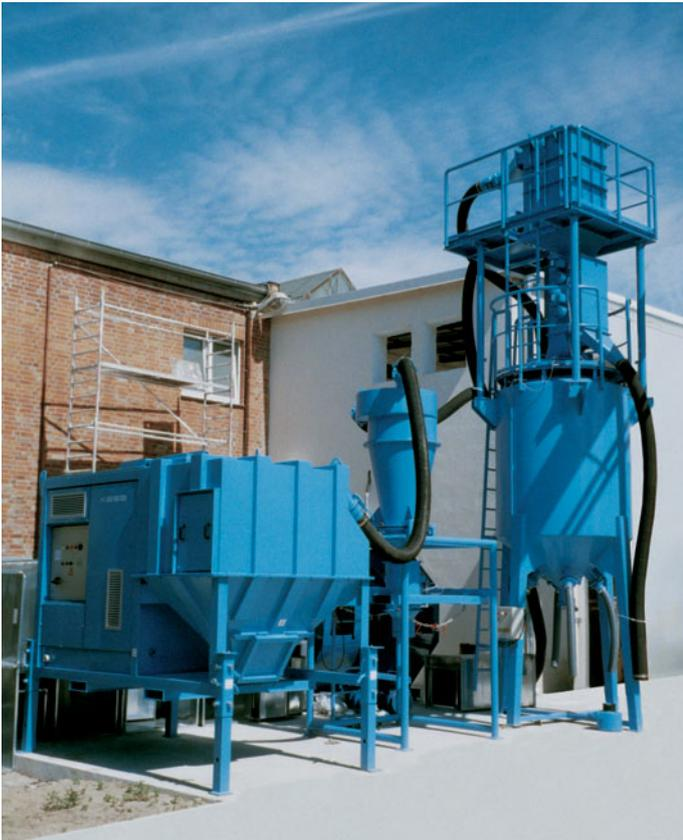
Mobile Strahlmittelaufbereitung mit Reiniger, Magnetabscheider, Vakuumsilo, Zyklonabscheider und Sauganlage.
