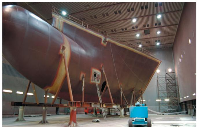
Kombinierte Strahl- und Beschichtungshalle für Schiffssektionen
