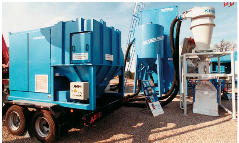
Dieselsauganlage mit Vakuumsilo und automatischer Staubabscheidung
